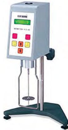
Figura 4.18. Viscosimetro BROOKFIELD DV-1+ con spindle e guardleg installati.
