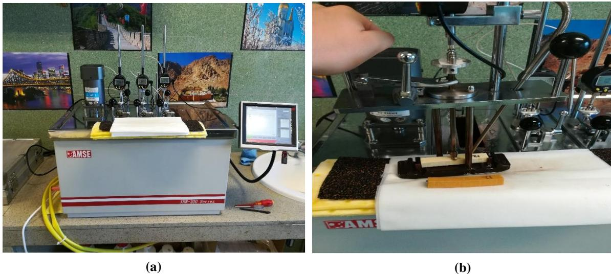
**Figura 3.4.** strumento AMSE XRW-300 SERIES per la determinazione della HDT. (a) Visione frontale, macchinario chiuso. (b) stazione di prova con un provino testato e uno da testare.
