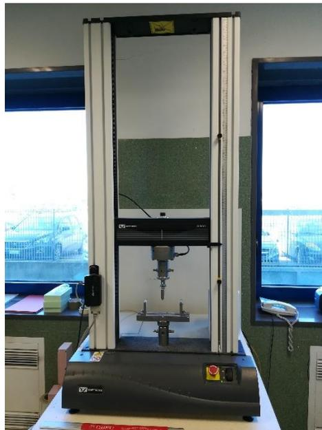
**Figura 3.1.** *Dinamometro Instron 3369, proprietà della ditta Eulithe.*
