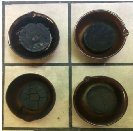
Figura 5.4: aspetto visivo dei formulati dopo il trattamento termico a 400°C.
