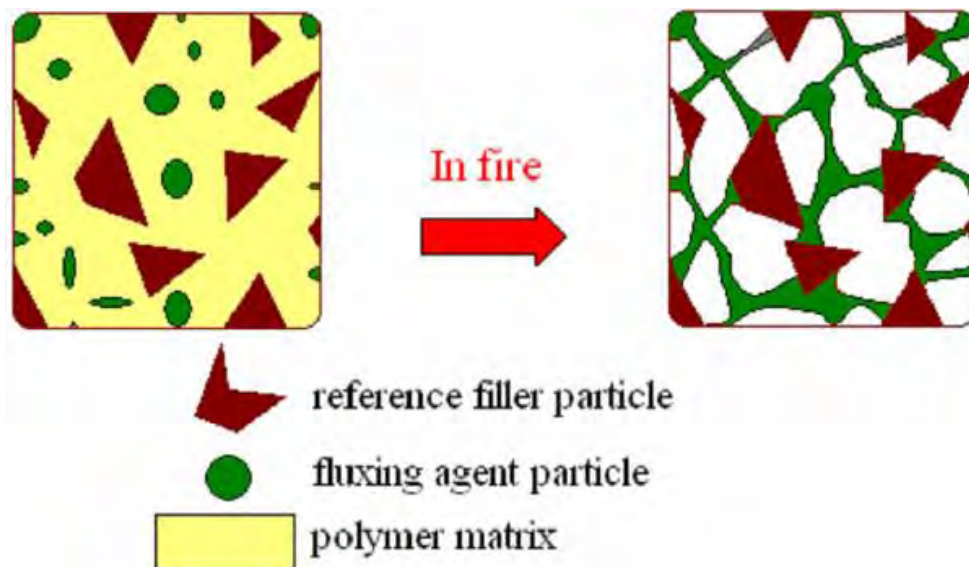
Figura 4.1: schema del meccanismo fisico di ceramizzazione coinvolgente l’azione del fluxing agent .
